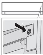
Utilizado quando o controle remoto está com mal funcionamento ou avariado. Levante o painel frontal:
