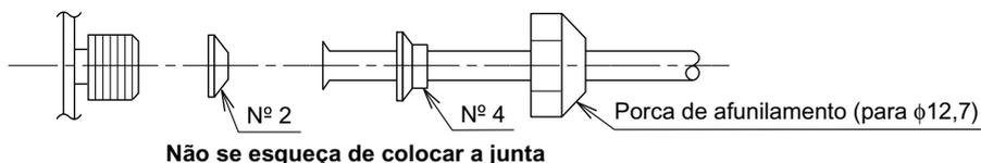
(4) Ligação de um tubo de φ12,7 a um orifício de ligação de um tubo de líquido de φ9,5:
