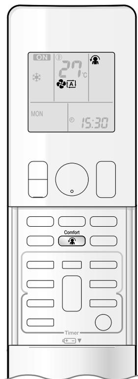
O caudal de ar ficará na direcção ascendente quando em operação REFRIGERAÇÃO e na direcção descendente quando em operação AQUECIMENTO, o que proporciona uma brisa suave que não entra em contacto directo com as pessoas.
