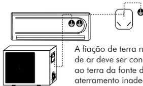
A fiação de terra no condicionador de ar deve ser conectada fixamente ao terra da fonte de energia. O aterramento inadequado pode causar choques elétricos ou outros riscos.
