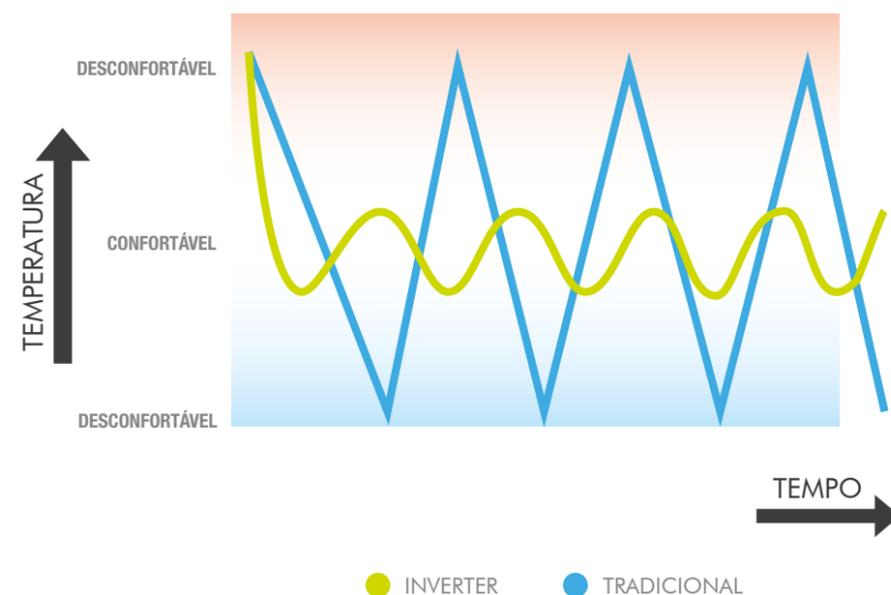
O funcionamento do compressor de forma constante faz com que o Inverter consuma menos energia.
