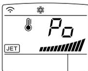
A função Jet Cool é usada para se obter um rápido resfriamento no verão. Quando esta função é acionada o produto opera na super velocidade de ventilação e a temperatura é ajustada para 18 °C pelos primeiros 30 minutos de funcionamento, para uma melhor eficácia na refrigeração. Semelhantemente a função Jet Heat (disponível em alguns modelos) aquece o ambiente rapidamente operando em alta velocidade e a 30 °C por 60 minutos.
