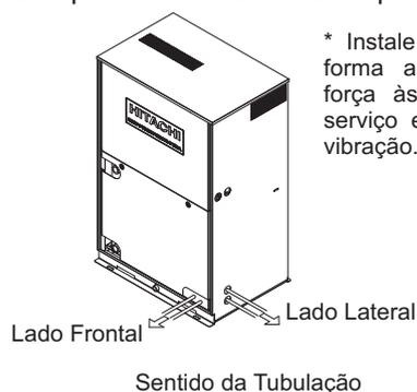
\* Instale os tubos de forma a não aplicar força às válvulas de serviço e minimizar a vibração.
