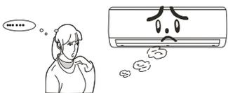
É normal em dias úmidos. Isto se deve a condensação do vapor de água em contato com o ar frio que sai do produto.
