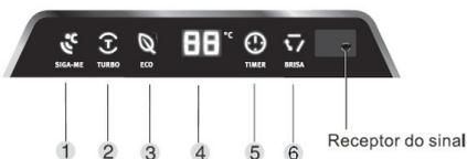
**Nota:** O acionamento das funções presentes no display da Unidade Interna é feito via controle remoto, portanto certifique-se que durante a seleção de qualquer função o controle remoto está direcionado ao receptor de sinal da Unidade Interna e não existem obstáculos que prejudiquem o envio deste sinal.
