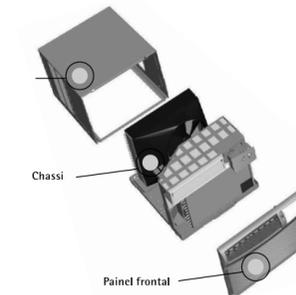
O cabo de alimentação possui aproximadamente 1 metro de comprimento. Dependendo da necessidade, ele pode ser posicionado tanto do lado direito quanto do esquerdo do produto. Caso deseje posicioná-lo do lado esquerdo, utilize um alicate para romper a passagem alternativa, localizada na parte interna do painel frontal.
